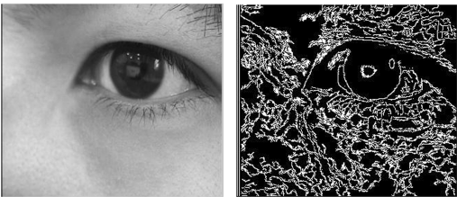
图 3 Canny 边缘检测效果 Fig. 3 Result of canny edge detection
